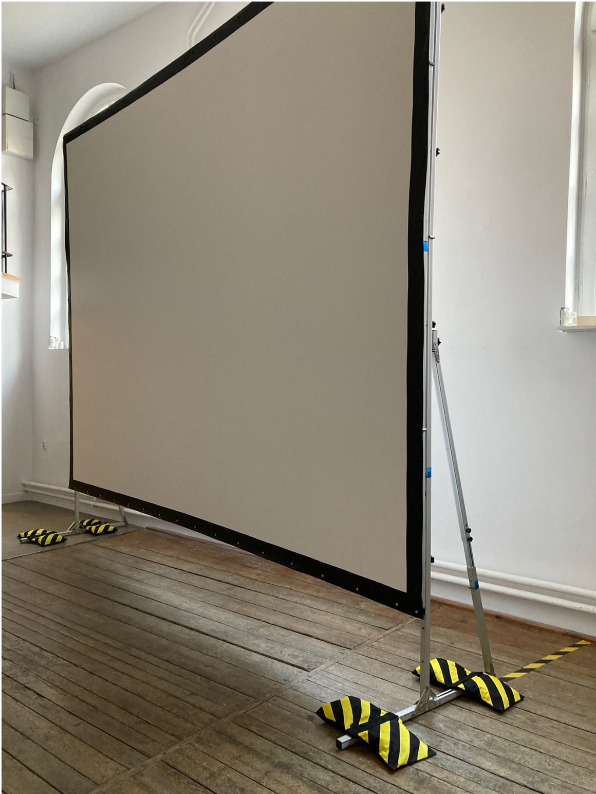
Obciążenie konstrukcji ekranu A. Fot. E. Łuczak
